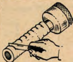
1. ábra. Késsel leszeletelünk a pumpa-tömlőből
