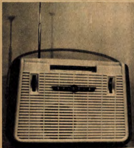
Műveltávolság, dobváltós, 10 tranzistoros rádió, külső hangszórócsatlakozóval, lemezlátszó-erősítővel
